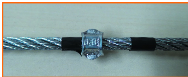
Fig.4 Pressatore compresso sulla fune Presser compressed on the rope
