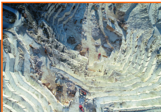
Fig.1a Foto aerea della Cava Michelangelo; è chiaramente visibile la configurazione a gradino diritto per fette orizzontali discendenti Aerial picture of the Michelangelo Quarry; the exploitation by horizontal descending benches is clearly noticeable (Photo P. Fresia)
