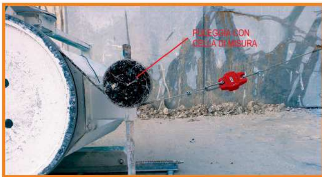
Fig.5 Taratura con dinamometro / Calibration with a dynamometer
