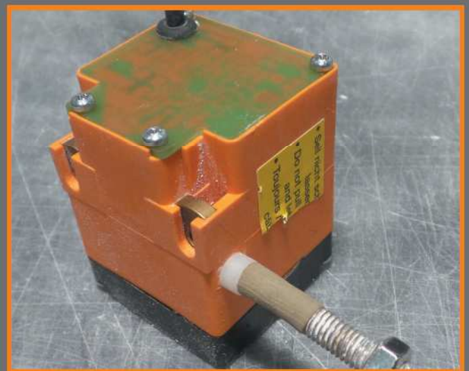
Fig.6 Estensimetro a filo (modello A40 prodotto dalla Kubler). Intervallo di misura 1000 mm, velocità massima 0,8 m/s, accuratezza \pm 0,15 mm, linearità \pm 0,35\% , intervallo di temperatura 0^{\circ} - 50^{\circ} I Draw-wire encoder (model A40, produced by Kubler). Measuring range: 1000 mm, maximum speed: 0.8 m/s, accuracy: \pm 0.15 mm, linearity: \pm 0.35\% , temperature range: 0^{\circ} - 50^{\circ}
