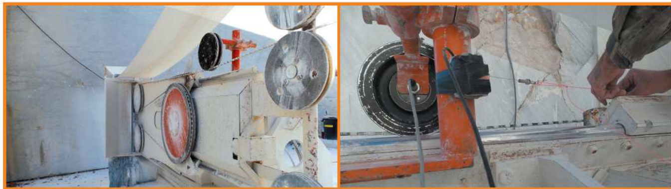
Fig.9 A sinistra, posizionamento cella di carico sull'Apuania Corsi MF 5000; a destra, installazione dell'estensimetro a filo Left, positioning of the load cell on the Apuania Corsi MF 5000; right, installation of draw wire encoder
