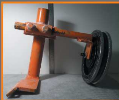
Fig.3 A sinistra, braccetto di sostegno della puleggia con cella di carico. A destra, rappresentazione schematica della piastra di fissaggio della cella di carico / On the left, support arm of the pulley with the load cell. On the right, schematic representation of the load cell fixing plate
