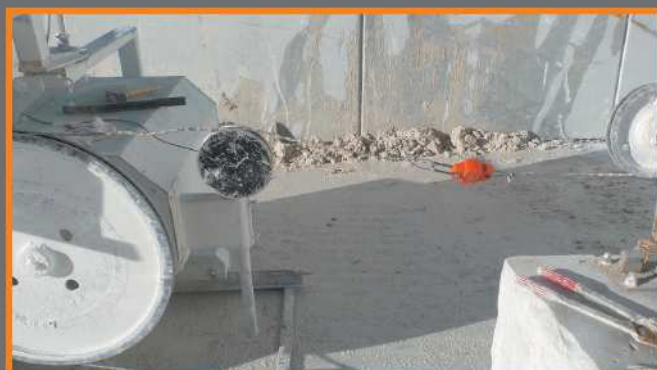
Fig.22 Fase di taratura del taglio al monte in configurazione 1, dinamometro sul lato superiore del filo / Calibration of the upstream cut in layout 1, dynamometer on the upper side of the wire
