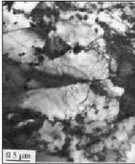
Figura 1.2-3 – Esempio di sottostruttura formata da sottograni (acciaio T91 sottoposto a creep)
