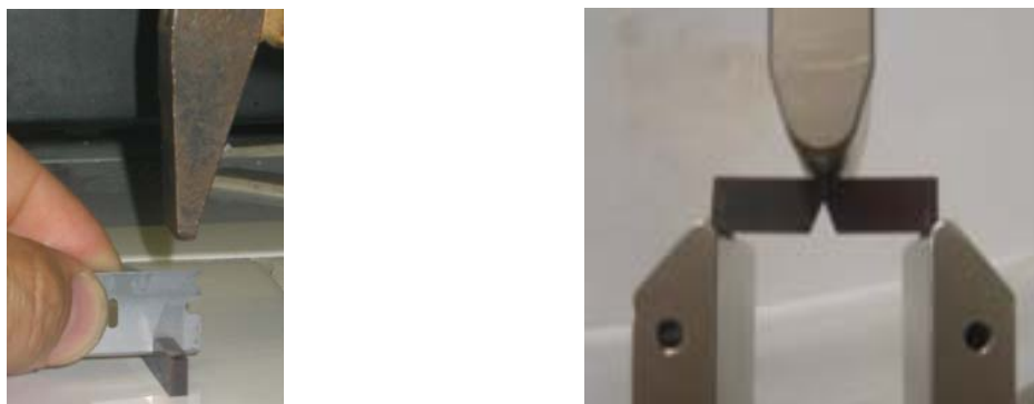
Figura 5.11: Fase di realizzazione dell'intaglio e prova di flessione.
