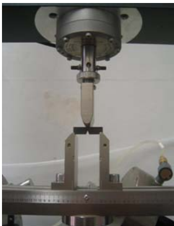
Figura 5.2: Immagini del provino SENB montato sul loading rig di flessione a tre punti.
